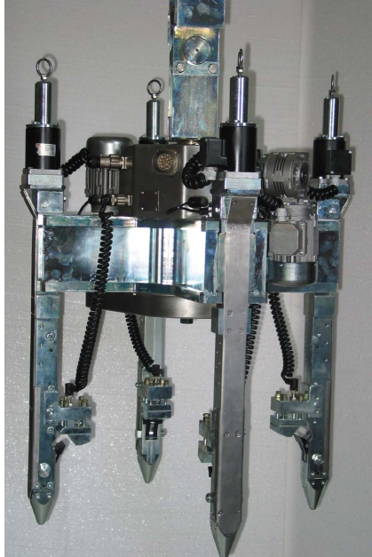
Pinza para bidones de 220 litros con motorización del giro y control automático de diámetro
