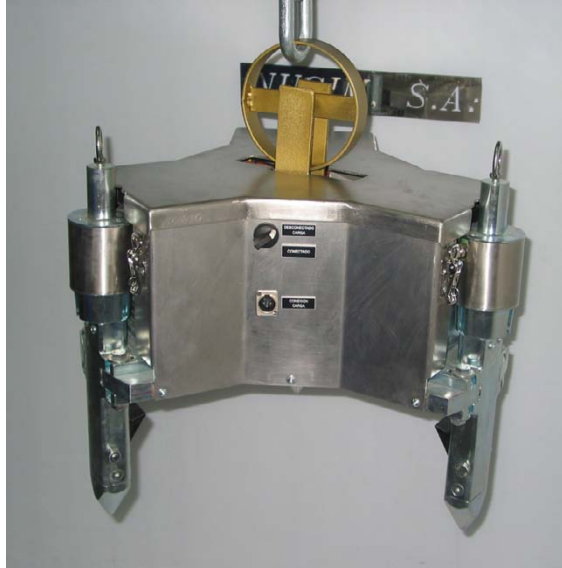
Pinza compacta para bidones de 110 litros
